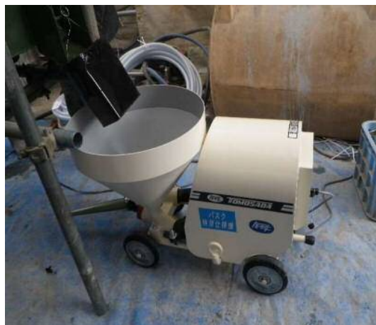
吹付け及びグラウト注入ポンプ
