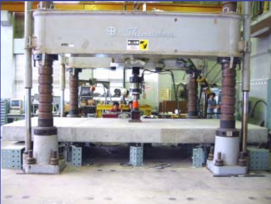
荷重分配試験状況 (中央載荷)
